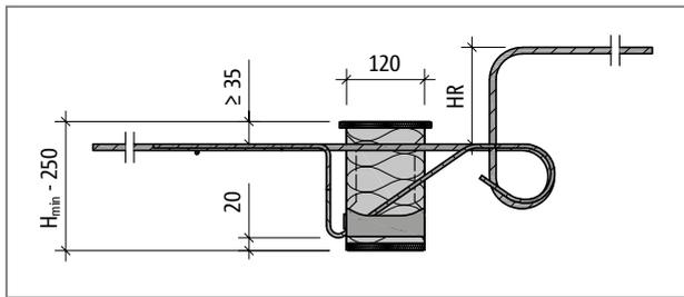
Fig. 78: Schöck Isokorb® XT type K-HV: Product section
