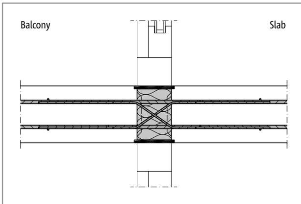
Fig. 206: Schöck Isokorb® XT type D: One-way spanning
