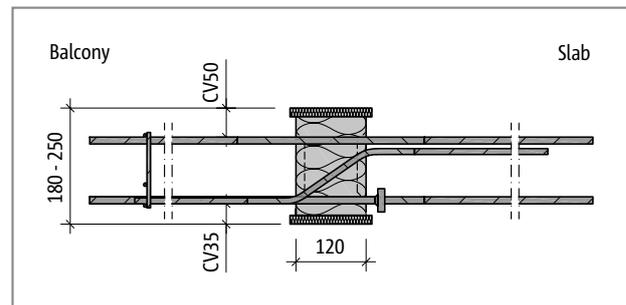
Fig. 65: Schöck Isokorb® XT type C-L-CV50: Product section
