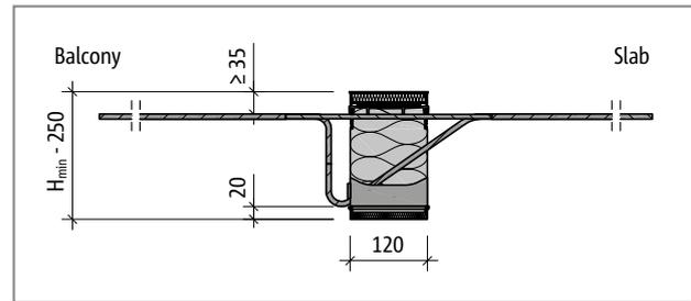
Fig. 30: Schöck Isokorb® XT type K-M5, M6: Product section
