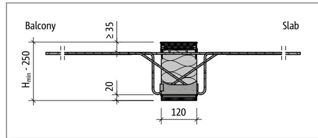
Fig. 34: Schöck Isokorb® XT type K-M5-VV1: Product section
