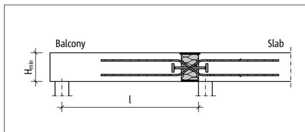
Fig. 157: Schöck Isokorb® XT type Q-P-VV: Static system
