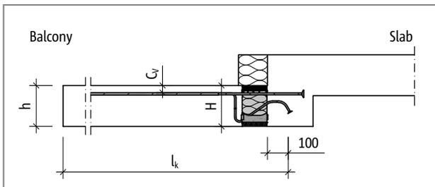
Fig. 95: Schöck Isokorb® XT type K-U: Static system
