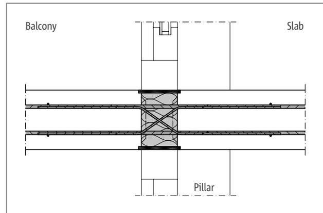
Fig. 207: Schöck Isokorb® XT type D: Two-way spanning
