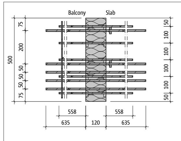
Fig. 67: Schöck Isokorb® XT type C-R-M1-V1: Product plan view
